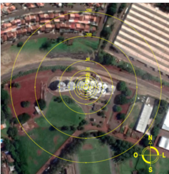
Figura 3. Sistema de medição da concentração de fofina nas proximidades da Unidade Armazenadora da Integrida Cooperativa Agroindustrial indicando os pontos de medição nas quatro posições Norte, Sul, Leste e Oeste. Cambé, PR, 2020.
