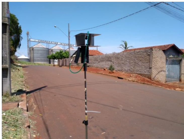
Figura 4. Base móvel em formato de tripé para colocação do medidor de fosfina no topo, usado nas proximidades da Unidade Armazenadora da Integrada Cooperativa Agroindustrial. Cambé, PR, 2020.
