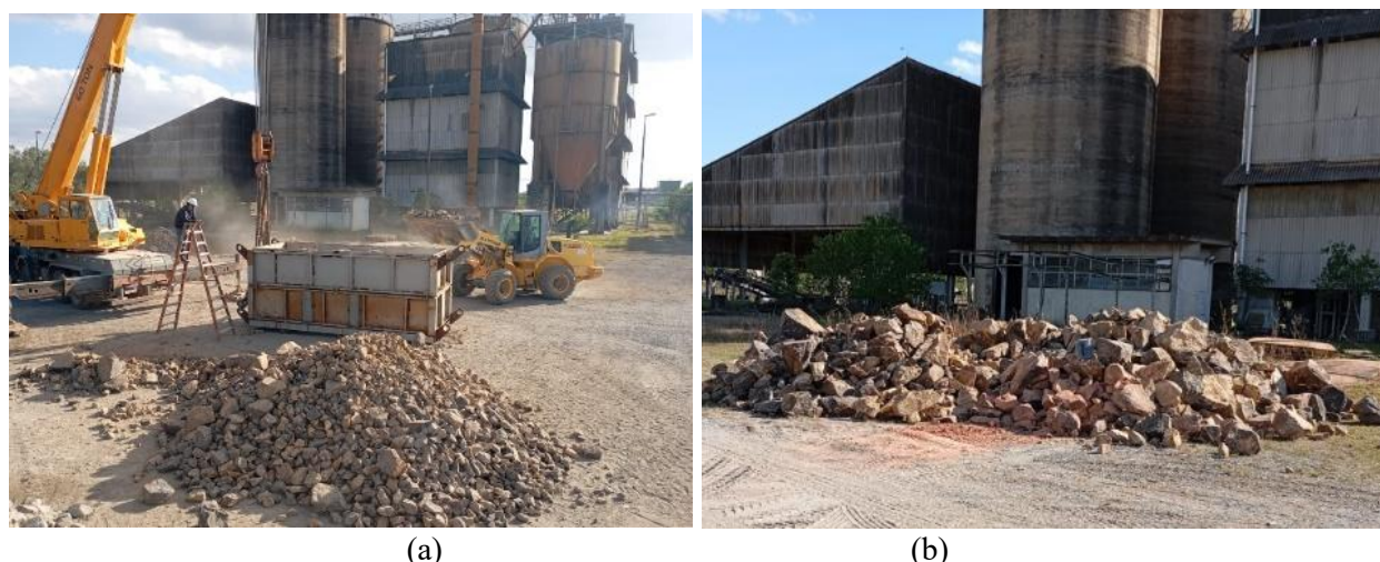
Figura 1. Granulometria do enrocamento estudado: (a) D 50 =150mm; (b) D 50 =600 mm.
