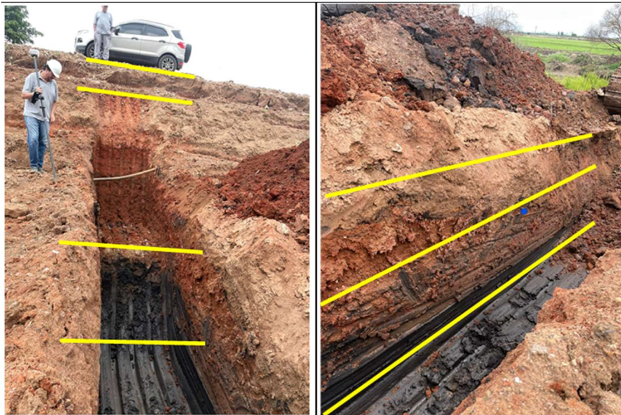
Figura 2. Perfis de solos (camadas) encontrados na fundação do dique do Pôlder Mathias Velho.
