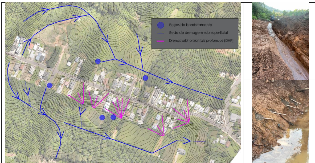
Figura 9. Locação das estruturas de drenagem dentro do loteamento (poços e DHPs), e trincheiras no entorno
