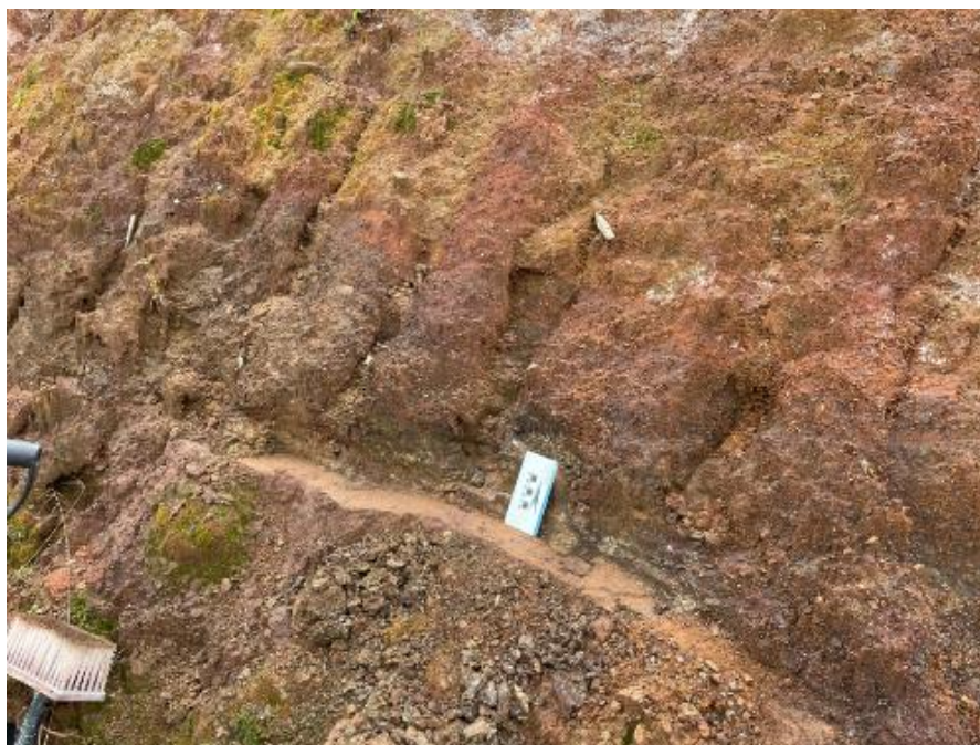
Figura 6. Superfície de ruptura próximo do nível da Rua Guilherme Dal Ri (material superior removido manualmente acima do plano de ruptura)
