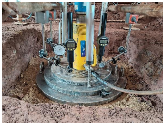
Figura 2. Disposição dos instrumentos para ensaios de placa.
