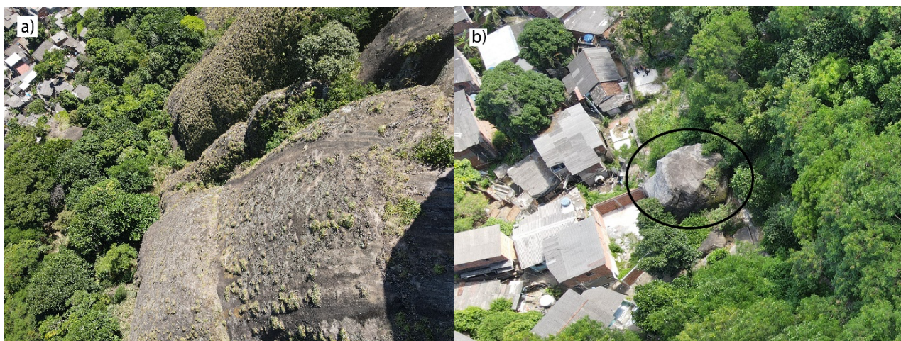
Figura 3. Imagens obtidas pelo levantamento feito com o drone. a) vertente do maciço com alta inclinação; b) bloco que deslizou em 2016.
