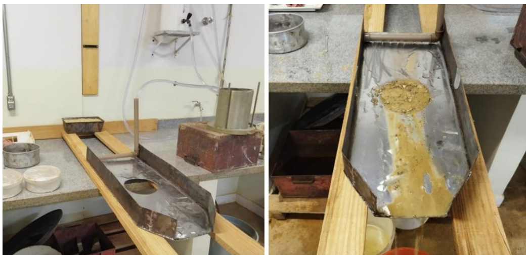
Figura 3. Equipamento de Inderbitzen e Realização do ensaio.
