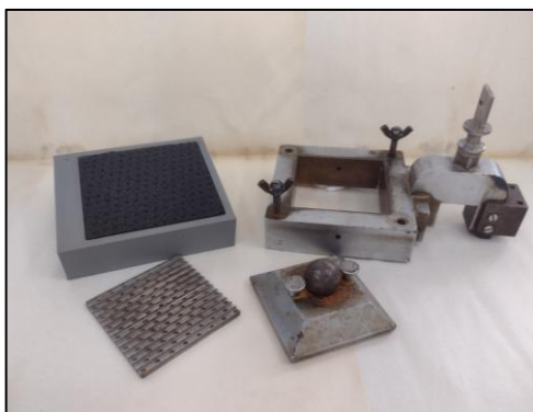
Figura 7. Cisalhamento direto: caixa bipartida (60mm x 60mm) com geomembrana fixada.
