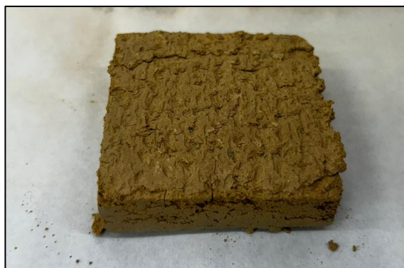
Figura 8. Corpo de prova pós ensaio: destaque para ranhuras causadas pela textura da geomembrana.
