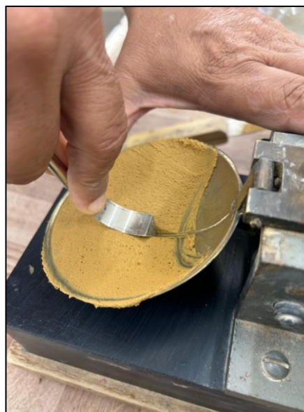
Figura 4. Limite de liquidez: corte com cinzel.
