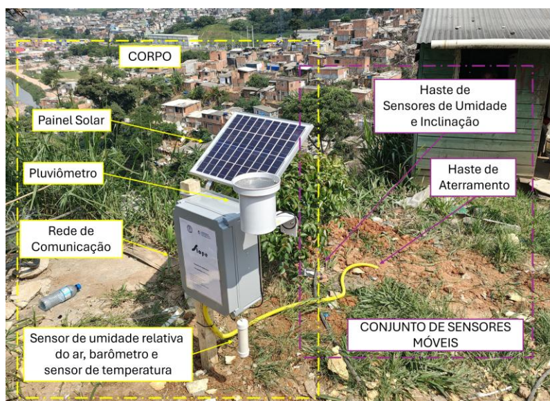
Figura 1. Estruturação do corpo do conjunto de sensores de sistema IoT em estudo.
