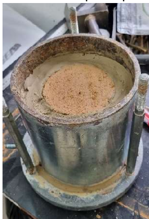
Figura 3: Posicionamento do corpo de prova no permeâmetro
