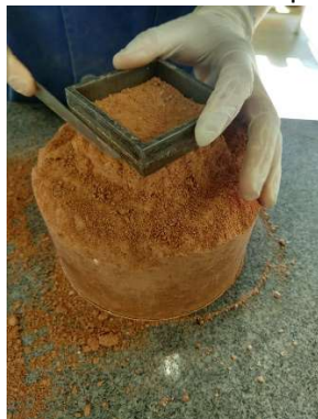
Figura 2. Cravando o anel metálico do ensaio de compressibilidade no cilindro de solo
