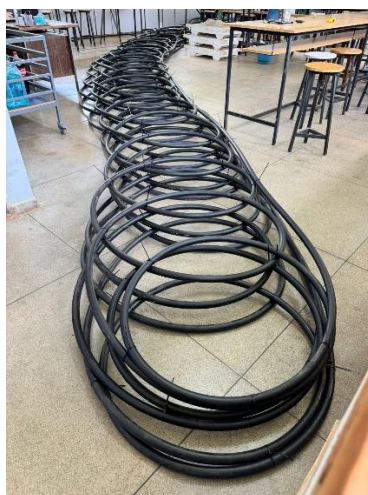
Figura 5. Montagem em laboratório das tubulações em arranjos slinky
