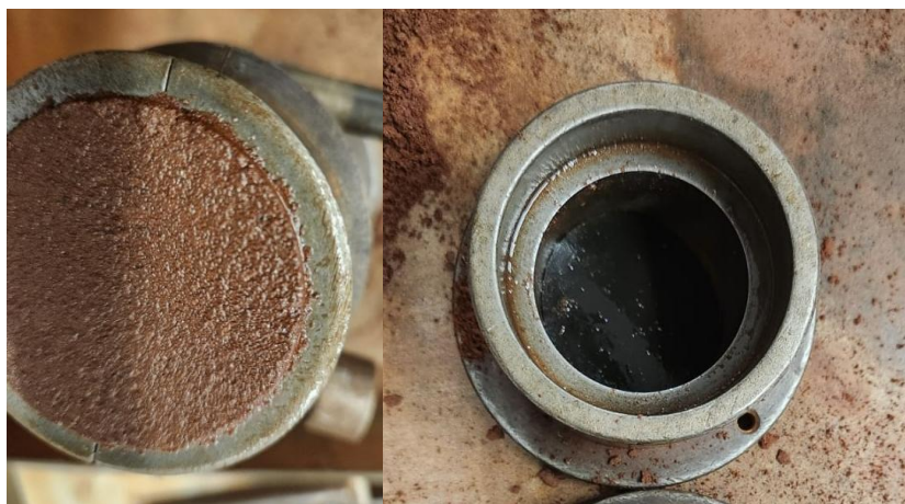
Figura 4: Expulsão de óleo durante processo de moldagem
