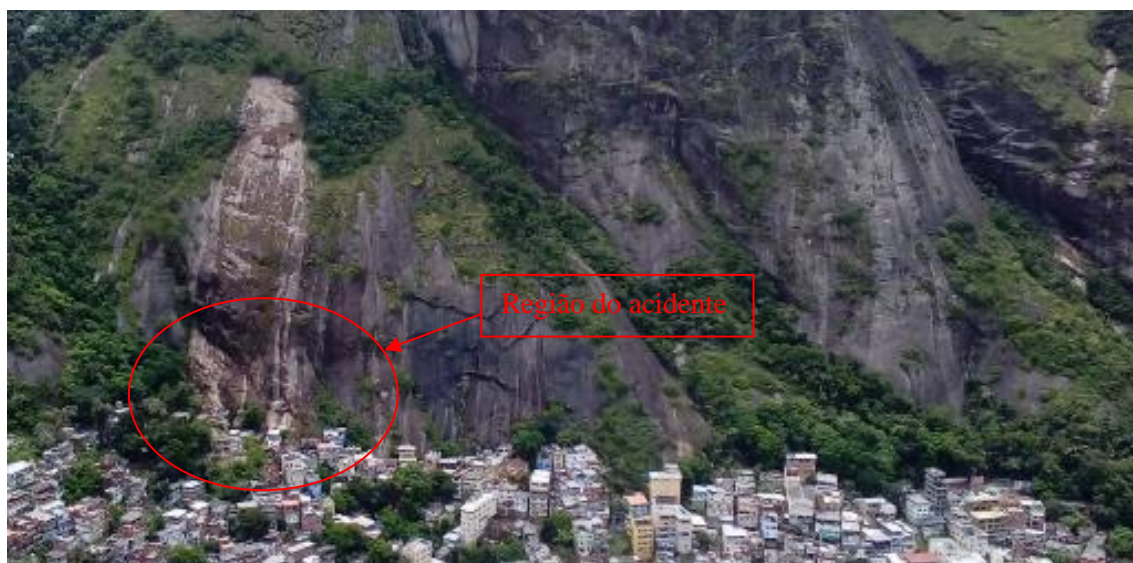
Figura 1. Vista aérea do Vidigal – Rua Major Toja Martinez Filho: perfis de intemperismo pouco espesso em encosta de forte declividade acima das escarpas rochosas, fornecem material para escorregamentos recorrentes. Fonte: adaptado de Fundação GEO-RIO (2021a).
