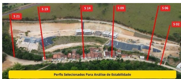
Figura 5. Perfis Tipo considerados para Análise de Estabilidade e Projeto de Estabilização dos Cortes (S02, S06, S09, S14, S19 e S21). Fonte: Autores, 2024.
