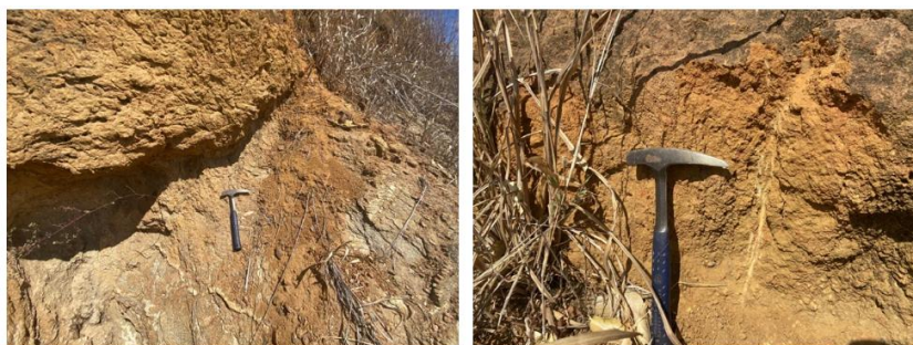
Figura 2. Afloramentos de alteração do gnaiss, identificados durante o mapeamento geológico-geotécnico da área.
