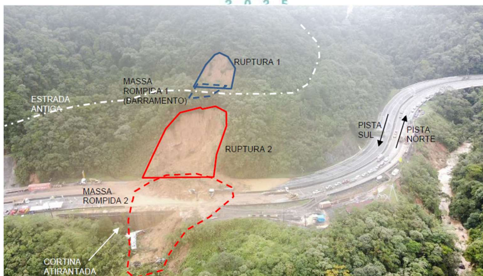
Figura 2. Vista frontal da ruptura, com indicação de elementos relevantes (30/11/2022).
