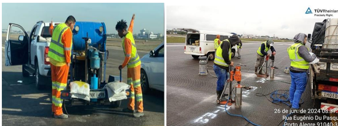
Figura 3. Equipes realizando a extração de Amostras no pavimento
