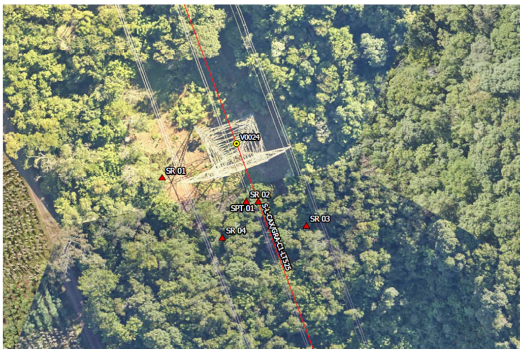
Imagem 22: local dos furos de Sondagem realizados com a imagem da antiga Torre 24
