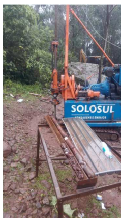
Imagem 23: Equipamento de sondagem modelo SS21-SONDEQ e caixa de testemunho
