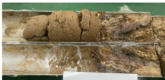
Figura 4. Camadas de argila plástica e material silto-arenoso com foliações, identificadas entre 19,50 e 20,40 m de profundidade
