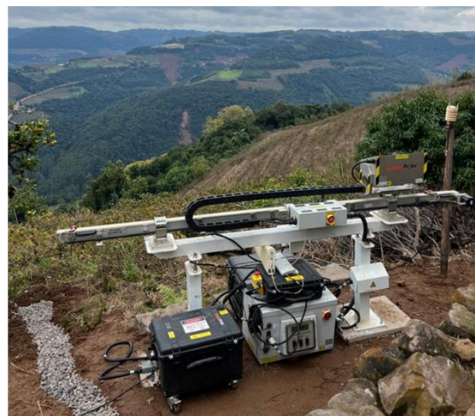
Figura 1. Instalação do radar SSR-SARx e indicação da massa rompida em ortofoto, maio 2024. (fonte: autores ).
