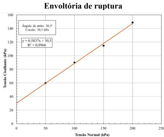
Figura 7. Envoltórias de Resistência obtidas nos Ensaios de Cisalhamento Direto com solos na condição inundada. Fonte: Autor, 2024.
