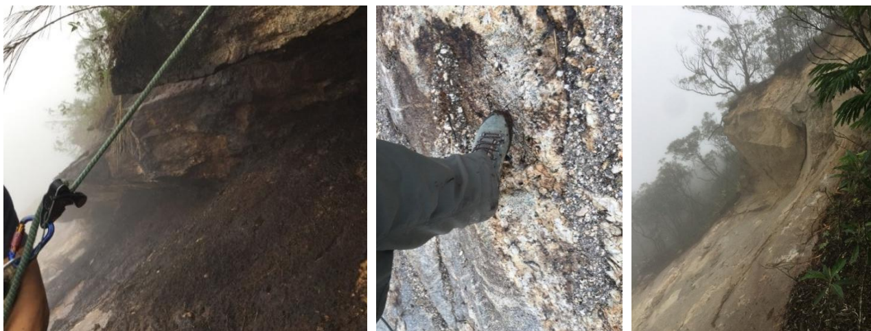
Figura 5. Plano de ruptura no flanco direito, presença de água no plano de ruptura, crista da ruptura com planos oxidados/intemperizados.
