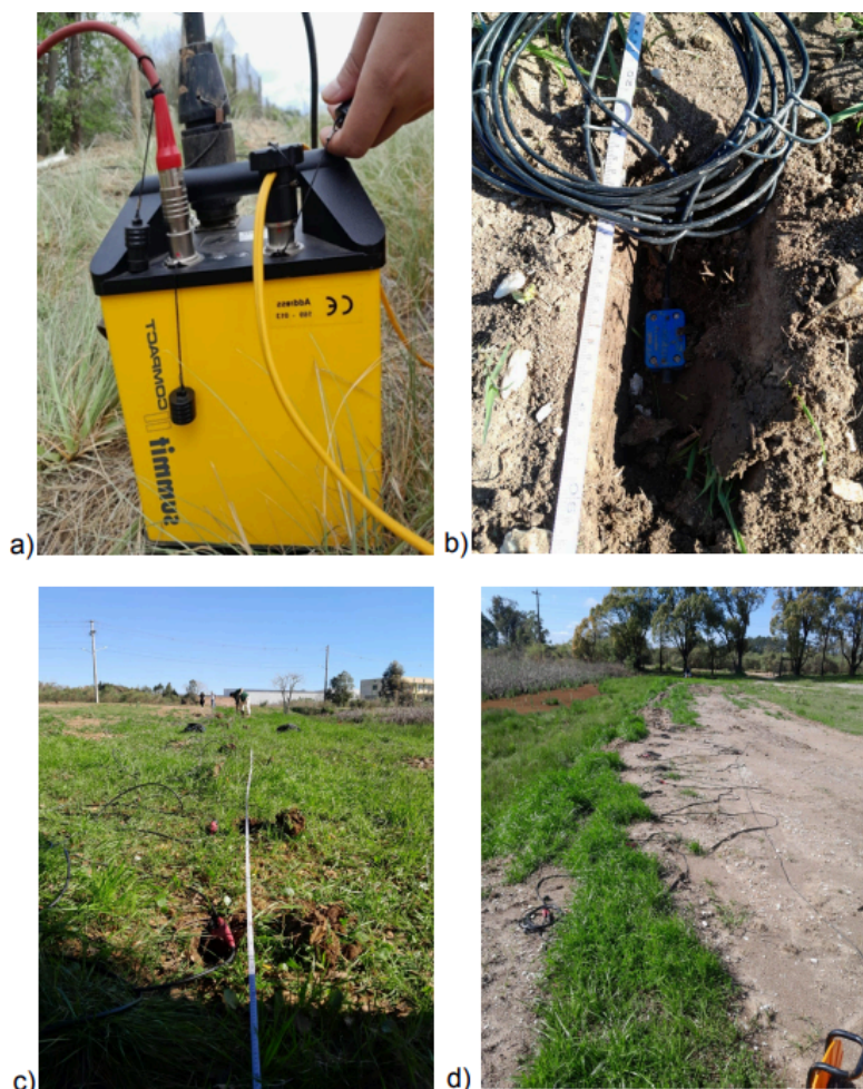
Figura 3. Mosaico de fotos da aquisição de dados de campo; em (a) sismógrafo SUMMIT II Compact; (b) geofone enterrado; (c) vista do início do perfil sísmico; e (d) vista do final do perfil.
