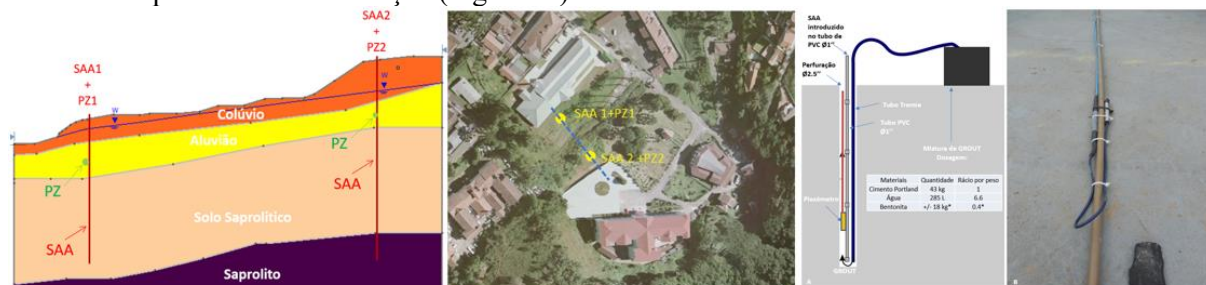
Figura 1 – Da esquerda para a direita: (a) Seção-tipo com estratigrafia local e posicionamento dos instrumentos (PZ e SAA); (b) vista aérea da área de estudo; (c) esquema da instalação conjunta de SAA e piezômetro no mesmo furo; (d) fotografia em campo do ShapeArray e piezômetro antes da instalação.
