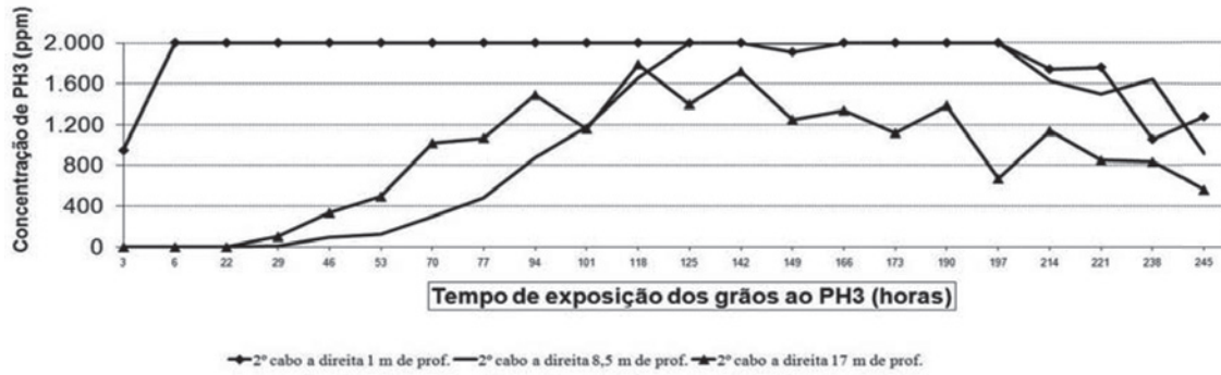
FIGURA 7. Monitoramento da concentração da fosfina (PH 3 ) medida em diferentes profundidades, durante o expurgo em silo metálico de 9.400 t, com distribuição das pastilhas de fosfina na superfície da massa de grãos sem circulação da fosfina. Coamo, Arapuã, PR, 2016
